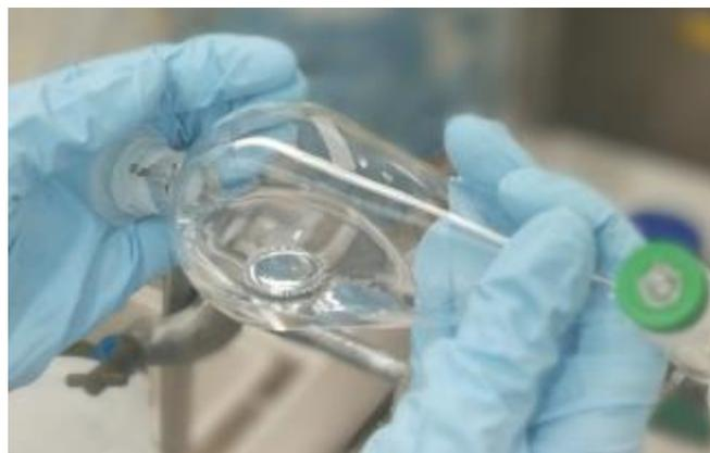
**Abbildung 8:** Waschen von Quecksilber mit verdünnter Salpetersäure im Labormaßstab in einem Scheidetrichter.
