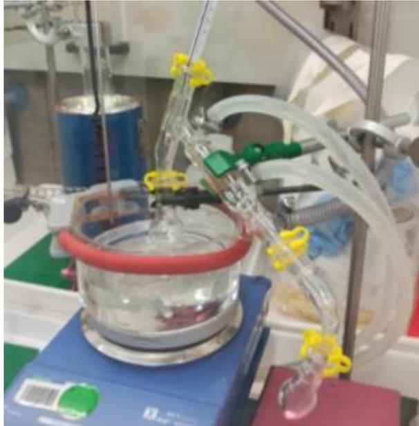
**Abbildung 7:** Mikro-Destillationsapparatur für die Vakuumdestillation von Quecksilber im Labormaßstab.
