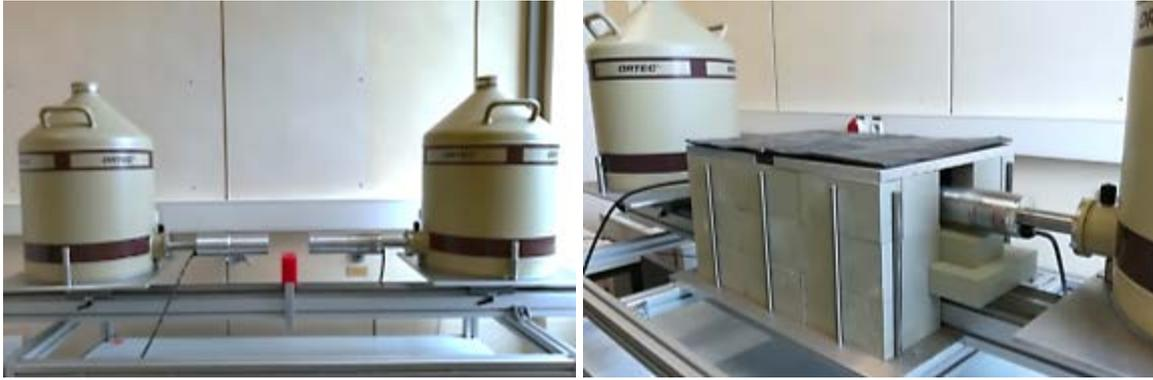
**Abbildung 10.** HPGe-Detektoranlage für die Messung von Quecksilberproben. Links: HPGe-Detektoren auf Linearverstelleinheit mit Probenhalter (rot). Rechts: Detektoranlage mit Bleiabschirmung.
