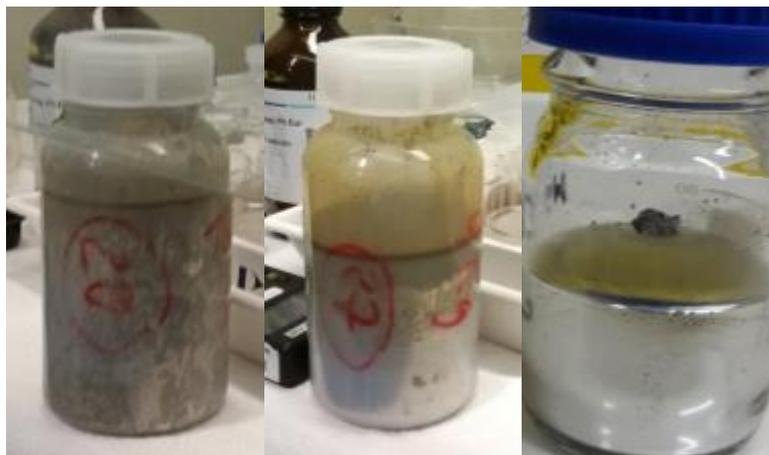
**Abbildung 9:** Quecksilberproben aus den Chemiezellen. Links, Mitte: Proben Nr. 20 und Nr. 27 mit flüssigem, öligem Film oberhalb des Quecksilbers. Rechts: Probe Nr. 18 mit Feststoffklumpen an der Flüssigkeitsoberfläche des Quecksilbers.
